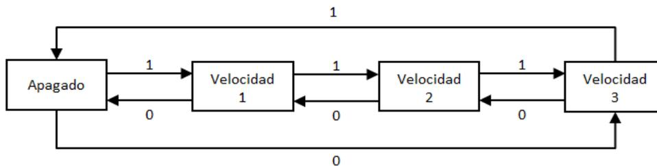
Figura 6. Control del ventilador por pasos cíclico
